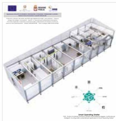
**U**n sistema ospedaliero mobile modulare caratterizzato da pannelli sandwich verticali, realizzati con materiali eco-sostenibili. Supporta percorsi di cura e diagnosi in ambienti completi di ICT per Accettazione-Registrazione, Preparazione Paziente, Sala Operatoria.
