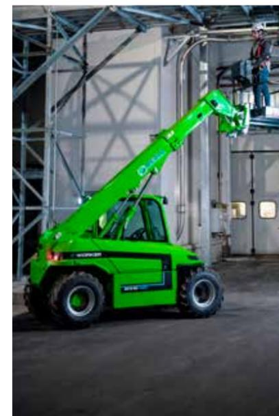
Il tuo MERLO, ma elettrico. La continua ricerca di soluzioni innovative ha portato la Merlo S.p.A. alla realizzazione di sollevatori telescopici full electric. Il nuovo e-Worker è l'ideale per spazi chiusi come magazzini e ambienti sotterranei, garantendo operatività e trazione anche in off-road.
